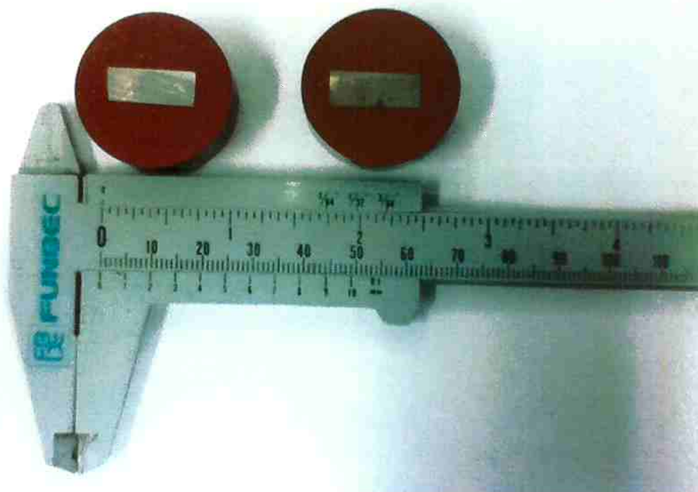
Figura 8 - Amostras lixadas e embutidas.
