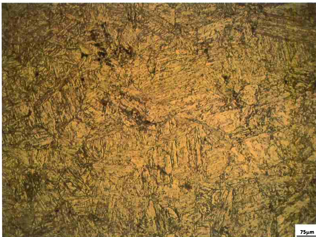
Figura 19 - Micrografias do aço no estado Austenitizado e Revenido obtidas por M.O. Nota-se estrutura de martensita revenida. Aumento de 200 vezes.
