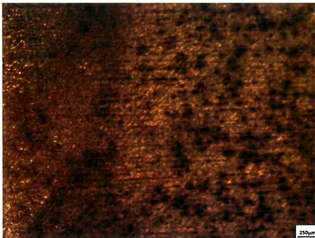
Figura 28 - Morfologia da corrosão de amostra Tal Como Recebida. Alta corrosão uniforme. Aumento 50X. M.O.
