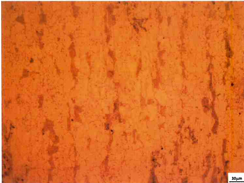
Figura 20 - Micrografias do aço, obtidas por M.O., na primeira tentativa de esferoidização. Nota-se algum esboroamento da perlita, comparativamente ao material sem tratamento (Figura 11). Aumento de 500 vezes.
