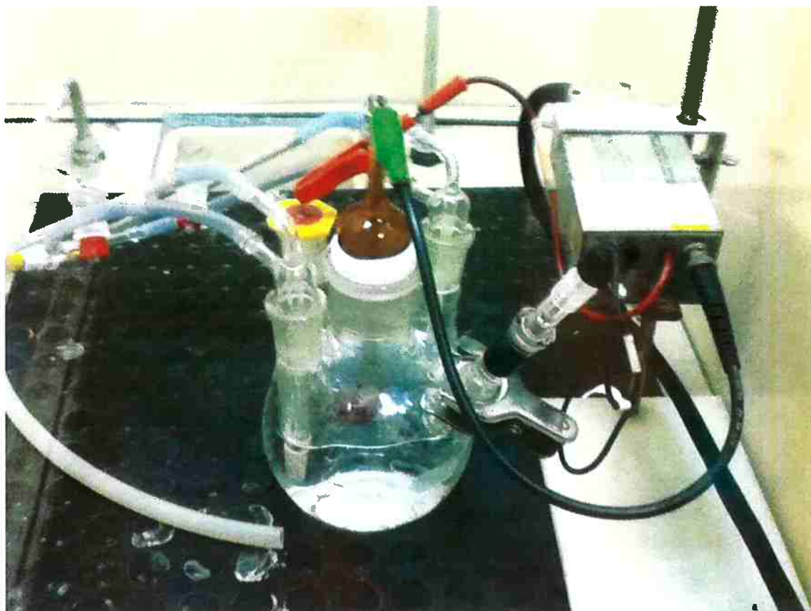
Figura 12 - Célula eletroquímica conectada ao potenciostato.
