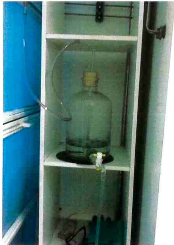
Figura 9 - Recipiente onde ocorre a primeira desaeração do eletrólito – Solução A.
