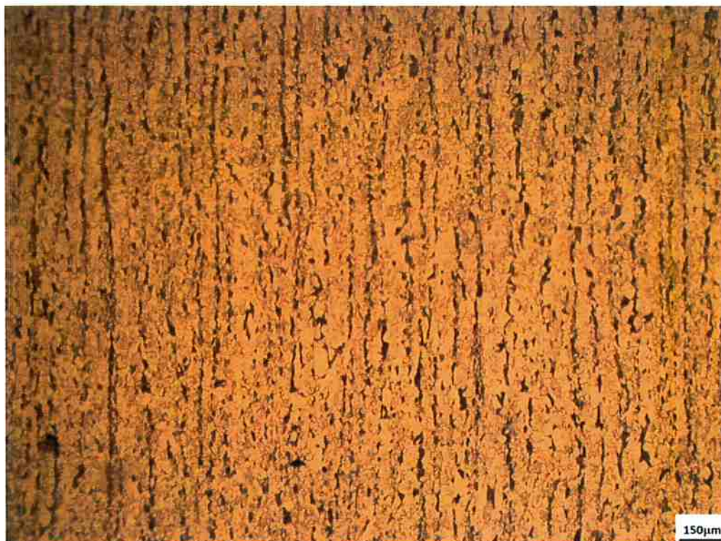
Figura 15 - Micrografia do aço no estado Tal Como Recebido obtidas por M.O. Nota-se estrutura bandeada de ferrita e perlita. Aumento de 100 vezes.
