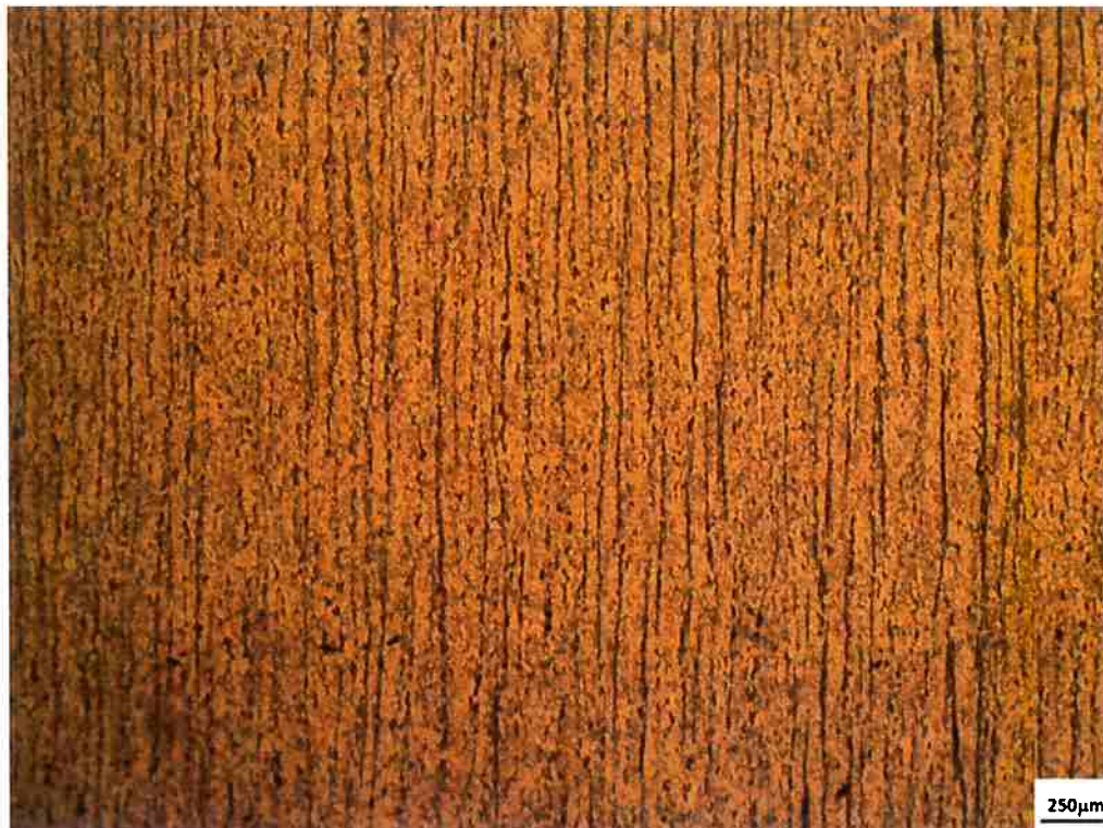
Figura 14 - Micrografia do aço no estado Tal Como Recebido obtidas por M.O. Nota-se estrutura bandeada de ferrita e perlita. Aumento de 50 vezes.
