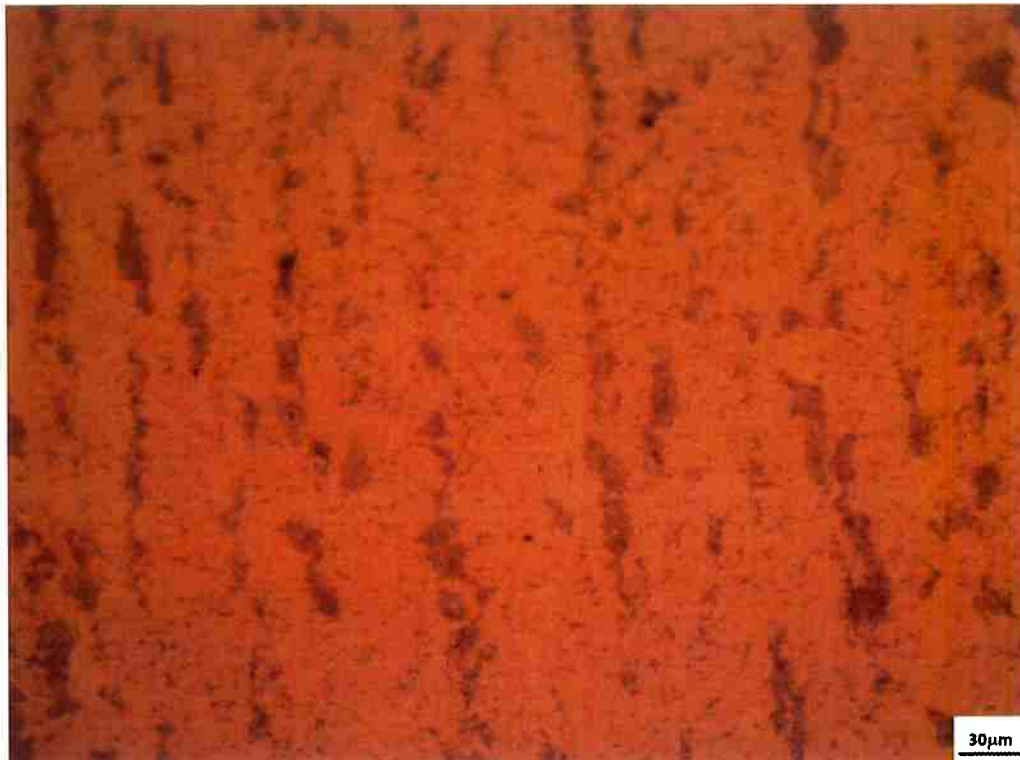
Figura 22 - Micrografias do aço na segunda tentativa de esferoidização obtidas por M.O. Nota-se maior desintegração da cementita, gerando partícula esféricas, comparativamente ao tratamento anterior (Figura 17 e 18). Aumento de 500 vezes.
