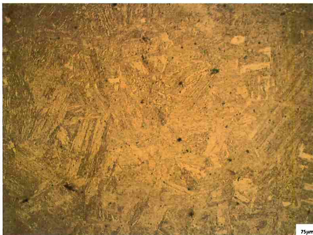
Figura 17 - Micrografias do aço no estado Austenitizado obtidas por M.O. Nota-se estrutura acicular, típica de martensita não revenida. Aumento de 200 vezes.
