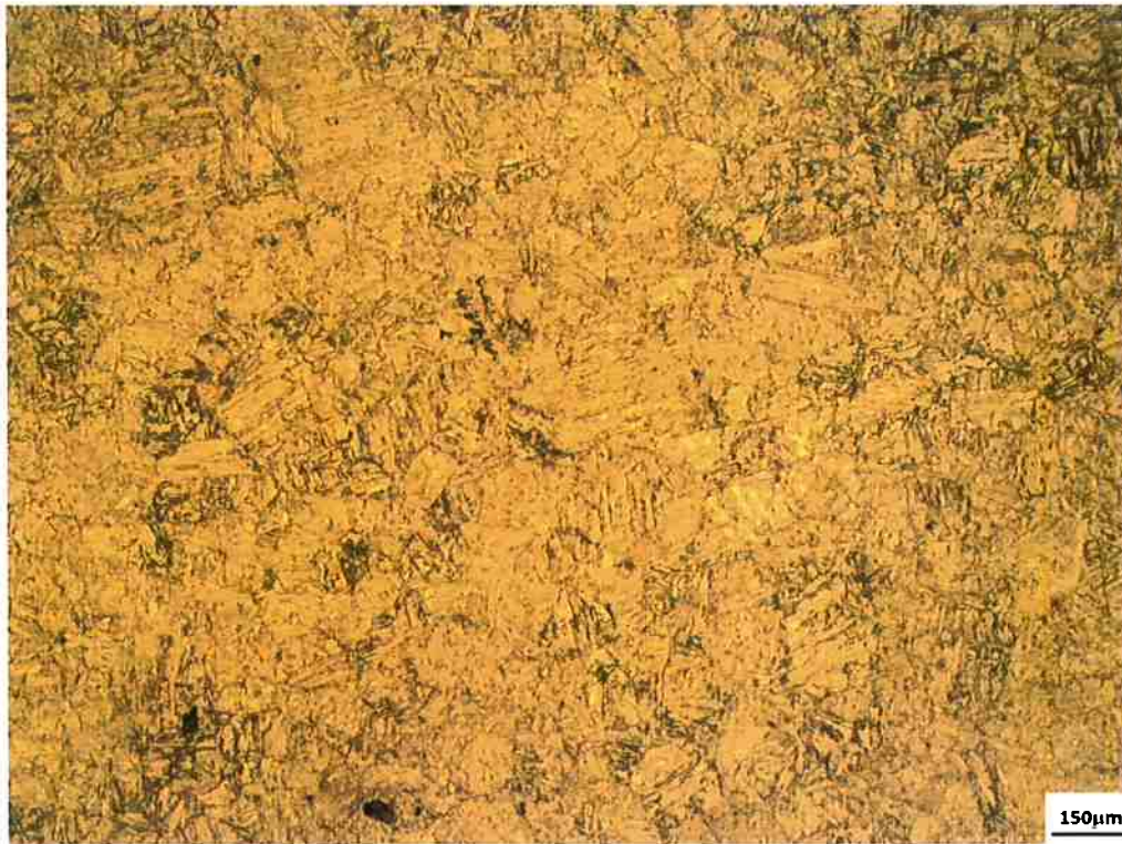
Figura 18 - Micrografias do aço no estado Austenitizado e Revenido obtidas por M.O. Nota-se estrutura de martensita revenida. Aumento de 100 vezes.
