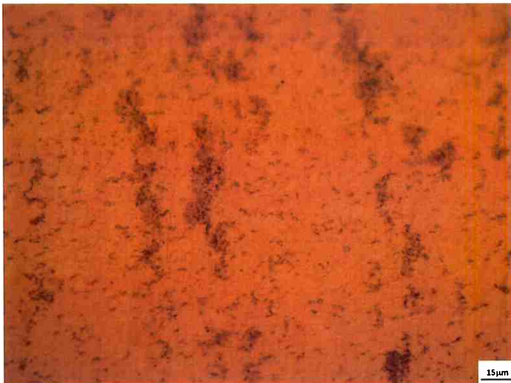
Figura 23 - Micrografias do aço na segunda tentativa de esferoidização obtidas por M.O. Nota-se maior desintegração da cementita, gerando partícula esféricas, comparativamente ao tratamento anterior (Figura 17 e 18). Aumento de 1000 vezes.
