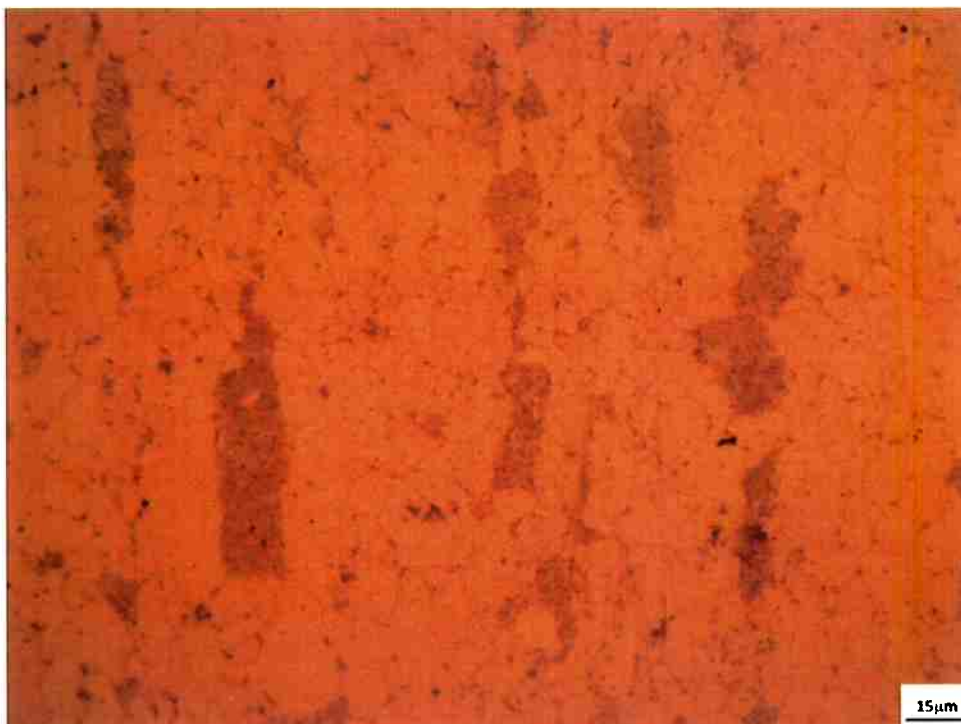
Figura 21 - Micrografias do aço, obtidas por M.O., na primeira tentativa de esferoidização. Nota-se algum esboroamento da perlita, comparativamente ao material sem tratamento (Figura 11). Aumento de 1000 vezes.
