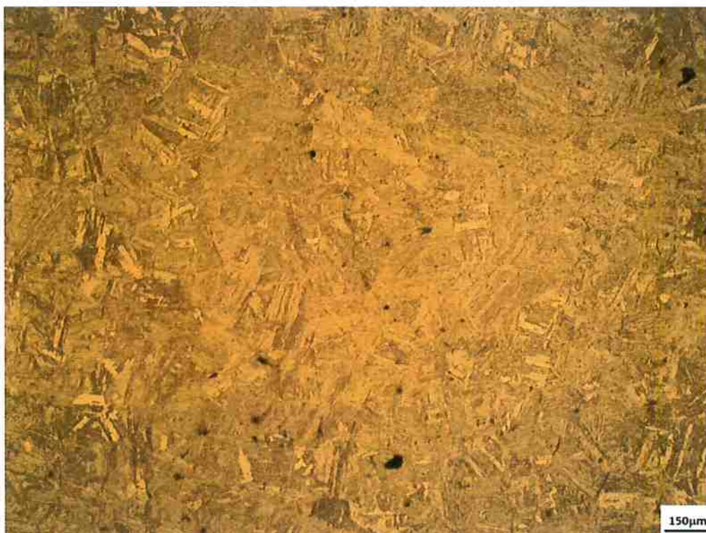
Figura 16 - Micrografias do aço no estado Austenitizado obtidas por M.O. Nota-se estrutura acicular, típica de martensita não revenida. Aumento de 100 vezes.
